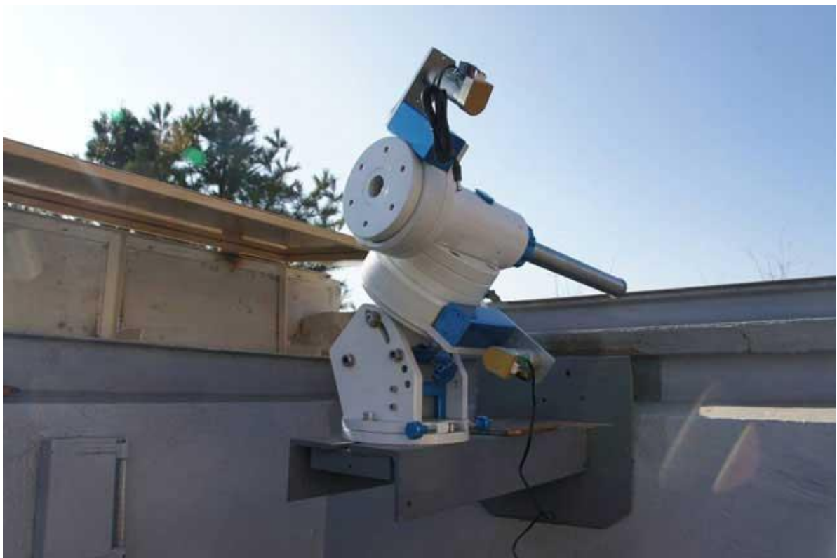
Figura 4. Telescopio GAS-250 con apertura de 25 cm., campo visual de 2.8x2.8 sobre montura WS-180. Este telescopio se encuentra ubicado en Ussurisk.
