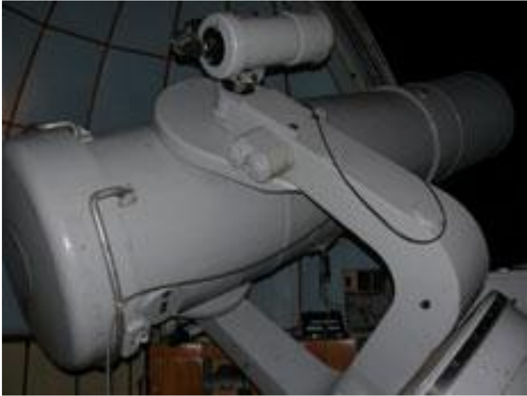
Figura 9. Telescopio AC-32 con apertura de 70 cm., campo visual de 45^{\circ} \times 45^{\circ} , cámara CCD. Este telescopio se encuentra ubicado en Abastumani.
