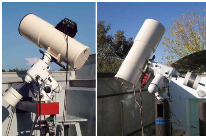
Figura 2. Telescopio ORI-22 con apertura de 22-cm y campo visual 5.5x5.5 grados, la cámara CCD PL4301E con montura EQ6Pro. Estos telescopios están ubicados en los observatorios de Milkovo, Usurisk, Blogovschensk, Lesosibirsk, Kitab, Naushni-1, Tiraspol.
