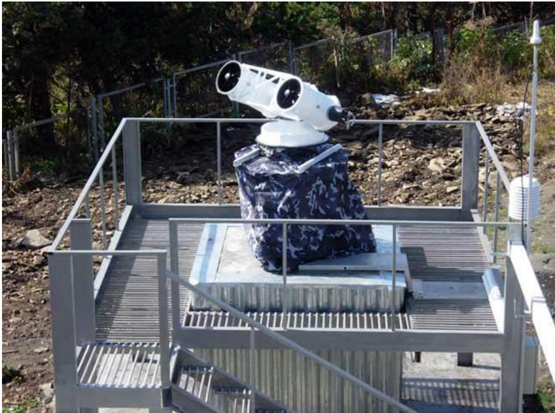
Figura 8. Telescopio Saschen-TM-D con apertura de 25 cm. Este telescopio está instalado en Argis.
