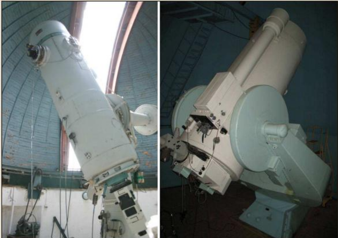
Figura 10. Telescopio AZT-8 con apertura de 70 cm., y cámara CCD ML47-10. Estos telescopios están ubicados en Chuguyev y Gissar. A la derecha el telescopio AZT-11 con apertura de 125 cm., campo visual de 10^{\circ} \times 10^{\circ} , con cámara CCD PL4301E. Este telescopio se encuentra ubicado en Abastumani.
