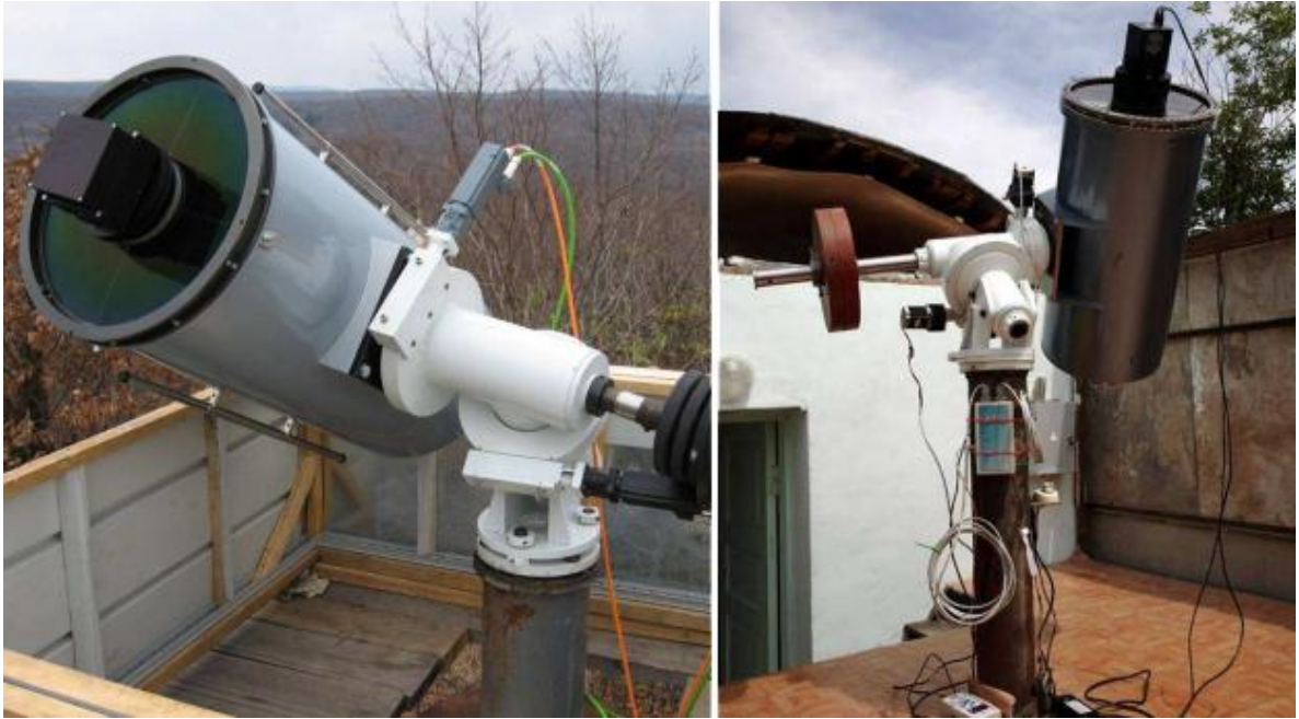
Figura 5. Telescopio ORI-50 con cámara CCD PL4301E y apertura de 50-cm sobre montura WS-300. A la derecha el telescopio ORI-40 con cámara CCD PL09000 y sobre la montura WS-24. Estos telescopios están instalados en los observatorios de Ussurisk y Kitab.
