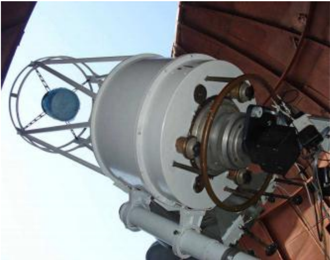
Figura 6. Telescopio RK-600 con apertura de 60 cm., y un campo visual de 17' \times 17' , con cámara CCD ML1001E. Este telescopio se encuentra ubicado en Mayaki.
