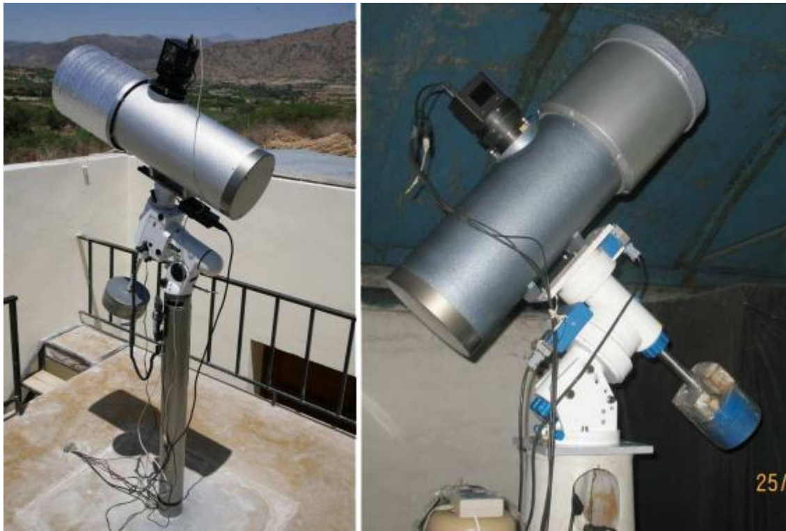
Figura 3. Telescopio ORI-25 con apertura de 25-cm y campo visual de 3.5x3.5 grados, una cámara CCD ML09000 sobre montura EQ6Pro. Estos telescopios se encuentran instalados en los observatorios de: Artem, Blagovshensk, Chuguyev, Tiraspol, Tarija y Cosalá.
