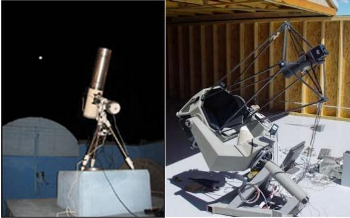
Figura 11. Telescopio SRT-220 con apertura de 22 cm., campo visual de 4.2^{\circ} \times 4.2^{\circ} y montura EQ6Pro. Este telescopio se encuentra ubicado en Nauchni-1 y Tiraspol. A la derecha Telescopio Centurión-18 con apertura de 45.5 cm., campo visual de 1.75^{\circ} \times 1.75^{\circ} , cámara CCD ML09000. Este telescopio se encuentra ubicado en Nuevo México.
